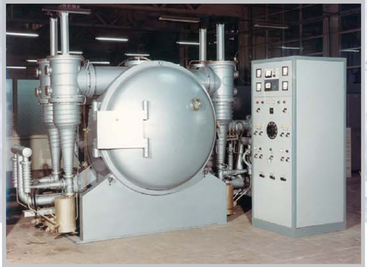
Primer equipo Kolzer de deposición por alto vacío: KI48" 1952
