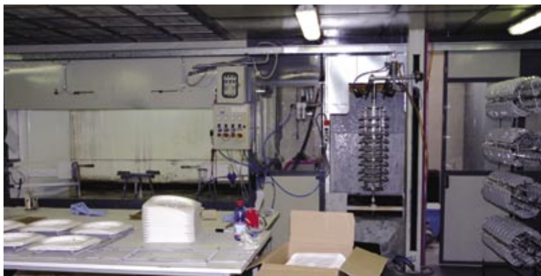
Fig. 5 - Un dettaglio della cabina manuale e della cabina automatica con reciprocatore
