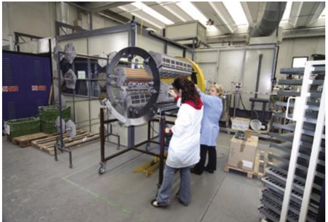
Fig. 8 - Il carico dei satelliti con particolari che saranno metallizzati e protetti sottovuoto con film nanometrico a base silconica e in seguito assemblati automaticamente senza essere ulteriormente manipolati
