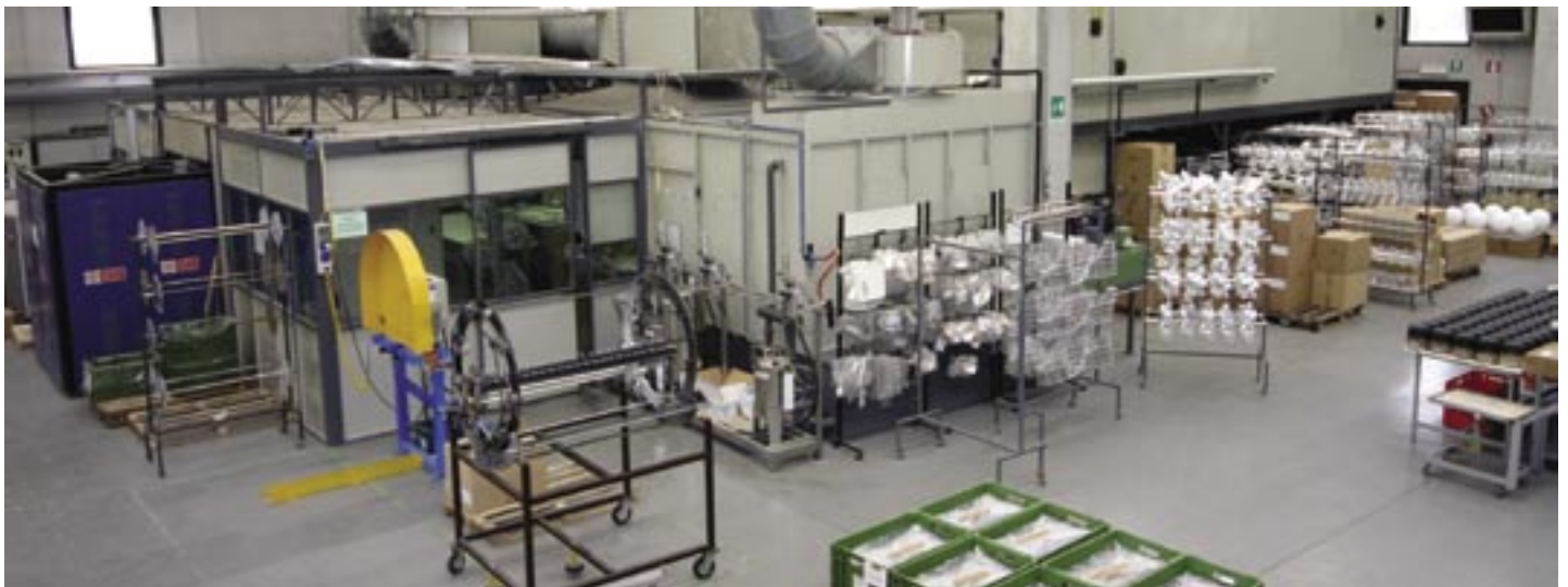
Fig. 4 - All'interno della camera pressurizzata e climatizzata sono situate una cabina robotizzata, un metallizzatore verticale, una cabina manuale, una cabina con reciprocatore per pezzi di piccole dimensioni, le bocche d'accesso ai forni di appassimento/essiccazione, i distensori (mantengono in rotazione le barre portapezzi durante l'appassimento dei fondi e/o delle finiture di metallizzazione)
