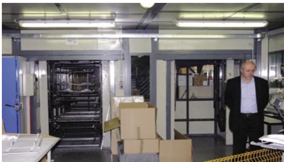
Fig. 7 - Un dettaglio delle bocche di carico/scarico dei forni (l'impiantistica è stata sviluppata dalla MI di Calò di Besana Brianza, che ha sviluppato negli anni una competenza specifica per le applicazioni dedicate alle fasi di verniciatura che precedono e seguono le fasi di metallizzazione e altri riporti sottovuoto)
