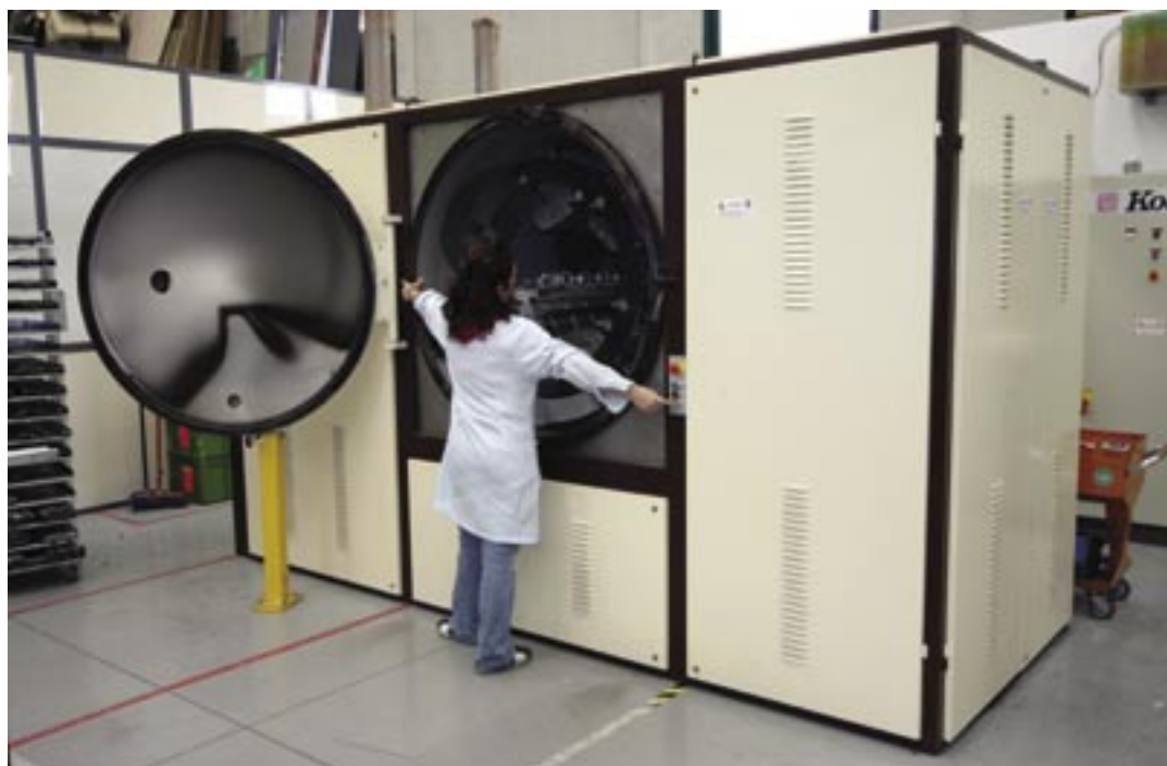
Fig. 10 - Il grande reattore (Kolzer) che permette di pretrattare i supporti che lo richiedono (scarico, ionica, plasma) ed effettuare riporti di tungsteno (metallizzazione), molibdeno, magnesio, siliconici, SiOx e altri monomeri, su qualsiasi tipo di supporto
